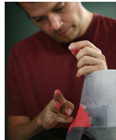
カーボン素材で実車を作る前に、原寸大のデザインモデルで風洞実験を実施。風洞内でクレイを使用して細部の形状を変更し、データ計測を繰り返す。この積み重ねが世界最高のエアロダイナミクスを実現する。
