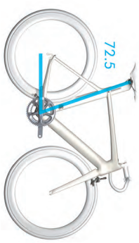
ポストを後方にセットすると、72.5° +/- のロードレーズに最適なポジションを実現
