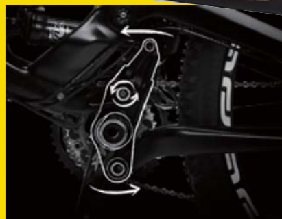
サスとホイールの動きに合わせて、BBの位置が可動
