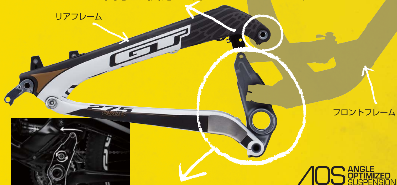
サスとホイールの動きに合わせて、BBの位置が可動
