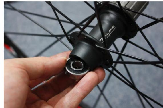
①できるだけ先端の面積が広い工具などでベアリングを叩き出す。
