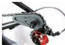
本体の角度を変えてテンションを調整できます。
