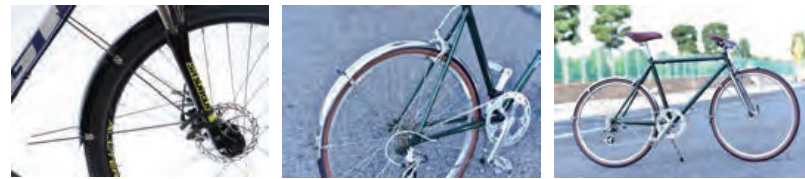
MTB27.5"/29"に取り付け 前後両方とも2本ステーの固定力に優れたフルフェンダー。 プラスチック素材で最高レベルの耐衝撃性を持つポリカーボネート素材を使用し、ハンマーで叩いても壊れません(アクリル素材の50倍)。
