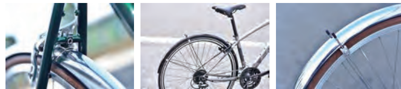
前後の吊り金具はステンレス製なのでキャリアブレーキの共締めに対応。 各種取り付けボルトが豊富で取り付けがスムーズ シルバーカラーはアルミ膜を透明なポリカーボネート樹脂でサンドすることで金属の質感を100%再現しながら、軽さと耐久性を両立。サンクラスにも使用される透明度の高いポリカーボネートの性能を活かした設計です。
