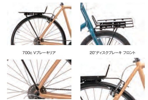
前クラウン 前Vブレーキ 前クイック(※別途135mmのQRシャフトが必要です。) 後ダボ(前もOK) 後Vブレーキ&ブリッジ
