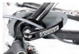
車輪を外した後のチェーンテンションを保つチェーンキーパー。
