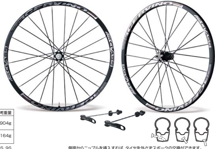
側面からニップルを挿入すれば、タイヤを外さずスポークの交換ができます。
