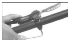
c1-2: ブレーキレバー固定クランプを固定する。
