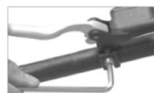
c-2: ブレーキレバー固定クランプを固定する。
