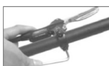
c1-2: ブレーキレバー固定クランプを固定する。
