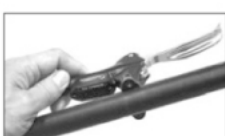
c1-1: ブレーキレバーの固定クランプをハンドルバーに添える。
